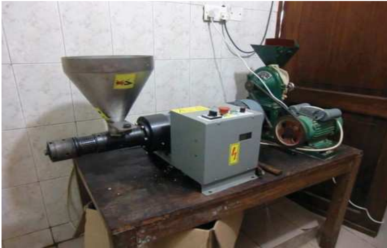
Links die Ölpresse, sie wurde in Einzelteile zerlegt mit dem Flugzeug aus Deutschland mitgebracht. rechts die Mühle für die Blätter. Hier wird Moringapulver produziert.
